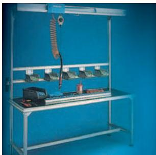
WBA es un banco de trabajo adaptado para montajes con herramienta neumática íntegramente realizado con perfiles HBS en aluminio anodizado. Incluye un carro completo ATS para suspender herramientas en alto. Una de las columnas está presurizada con la función de alimentar la guía de alimentación de la vagoneta.
