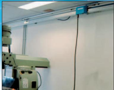
Brazo giratorio presurizado para alimentar herramienta neumática en un amplio radio de acción.
