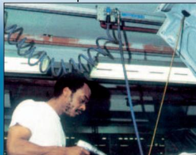
Vagoneta deslizante sobre perfil de aluminio para alimentar y deslizar herramienta neumática.
