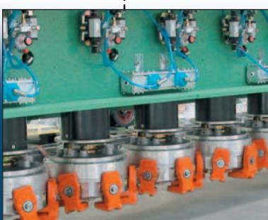
Colector de distribución integrado en cuadro neumático de control para la automatización.
