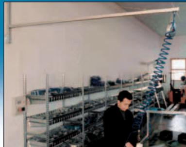
Brazo giratorio para banco en aluminio anodizado para soportar y alimentar herramienta neumática.
